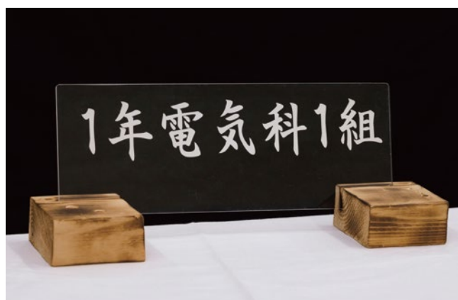
CorelDRAWとレーザー加工機で制作したアクリル製のプレート
