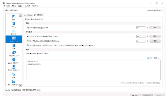
CPU 最適化を構成するには、[CPU 最適化を有効にする] オプションを選択し、以下の説明に従って値を指定します。
