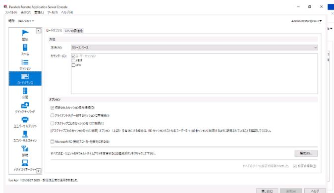
サイトで複数のサーバーが使用可能な場合、ロードバランスはデフォルトで有効になります。リソース ベースがデフォルトの方法ですが、[方法] ドロップダウン リストから変更できます。
